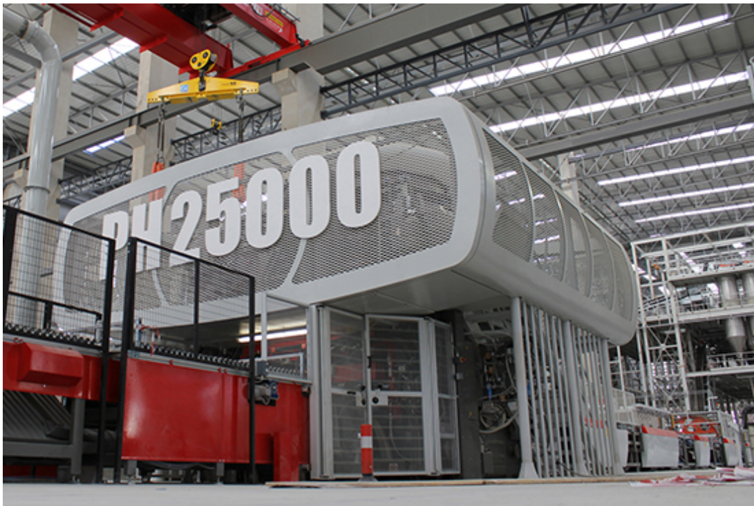
Jede DKTN Platte wird mit 25'000 Tonnen in der Presse hochverdichtet Bild: Cosentino
