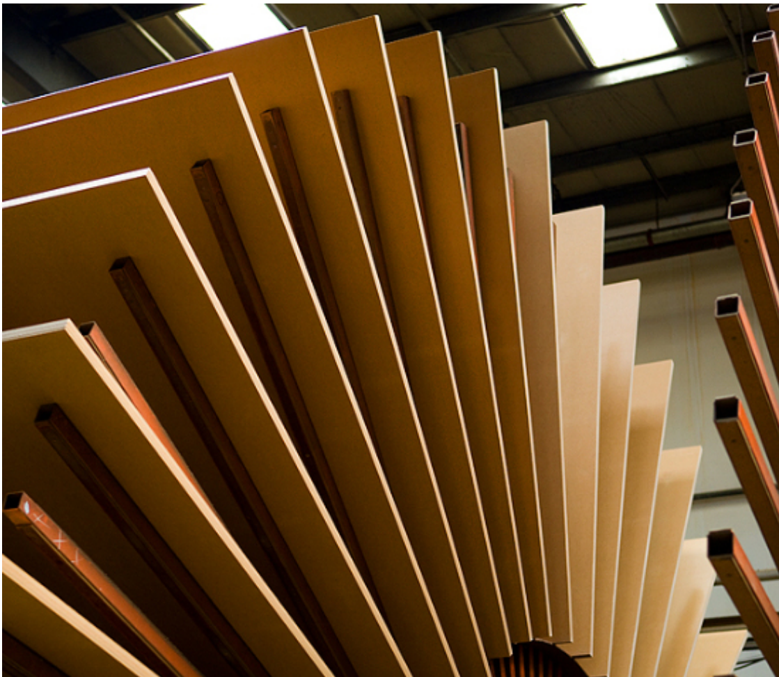
Abkühlung von Spanplatten im Kühlsternwender
